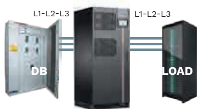
instalación de 3 conductores (L1-L2-L3)
