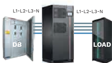
instalación de 4 conductores (L1-L2-L3-N)
